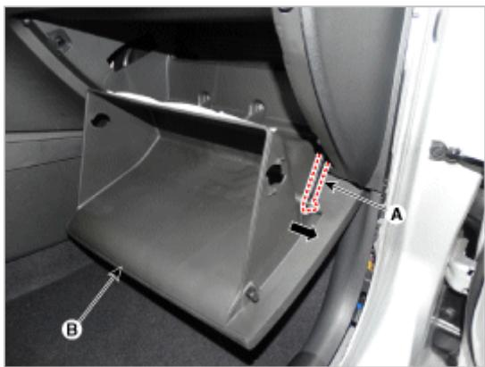
4. 分离支撑销(A)，并拆卸手套箱(B)。
