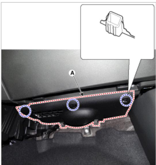
7. 拧下固定螺钉，并拆卸仪表板造型[右] (A)。
