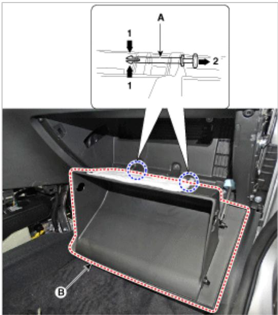
5. 使用螺丝刀或拆卸工具拆卸仪表板侧盖 [右] (A)。
