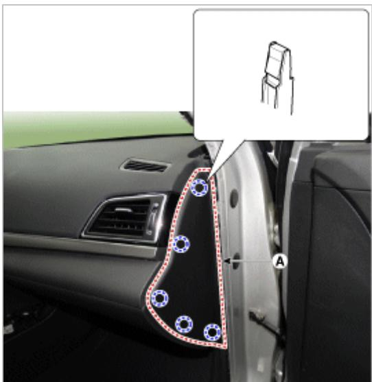
6. 使用螺丝刀或拆卸工具拆卸仪表板下盖 [右] (A)。
