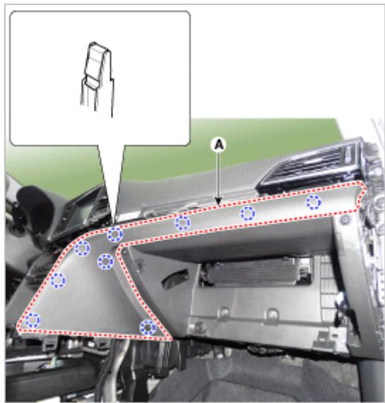
9. 拧下固定螺钉和螺母，并拆卸手套箱上盖总成(A)。
