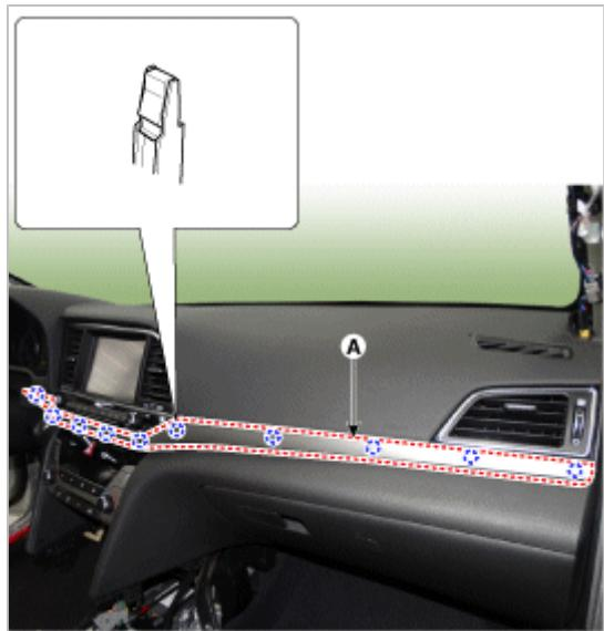
8. 拧下固定螺钉，并拆卸仪表板侧面装饰条总成[右] (A)。
